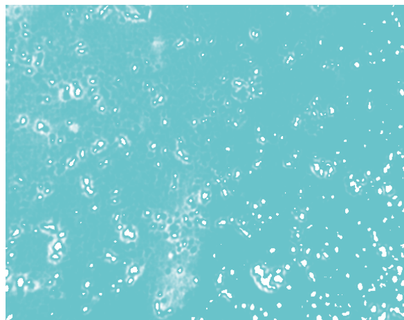
Рисунок 4 – Микрофотография кристаллов парафинов нефти Акшабулак с присадкой ДП-СМАО при 10°С
