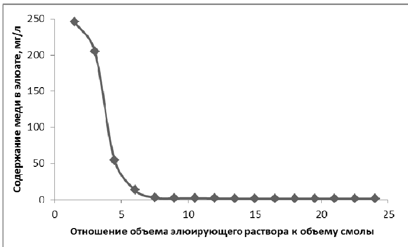
Рисунок 4 – Зависимость содержания меди в элюате от отношения объема элюирующего раствора к объему смолы при концентрации 20 % NaCNS + 4,0 % NaOH
