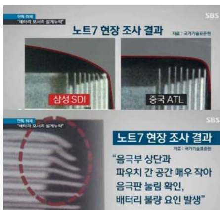
Рисунок 4 – Дефект в корпусе смартфона Galaxy Note 7 [11]
