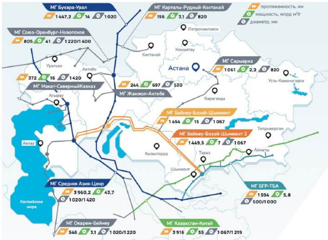
Рис. 4 – Маршруты транспортировки природного газа Казахстана (Fig. 4 – Natural gas transportation routes of Kazakhstan)
