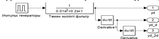
3 сурет. Simulink-те тірек блогының құрастырылған схемасы (Fig. 3. Compiled scheme of the support block in Simulink)
