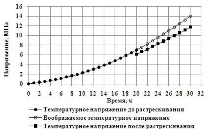
Рисунок 28. Изменение температурного напряжения в асфальтобетонном покрытии до и после растрескивания
