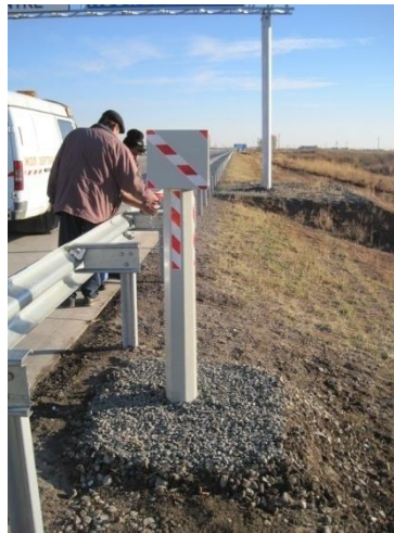
Рисунок 12. Измерительный (надземный) блок комплекта датчиков температуры и влажности
