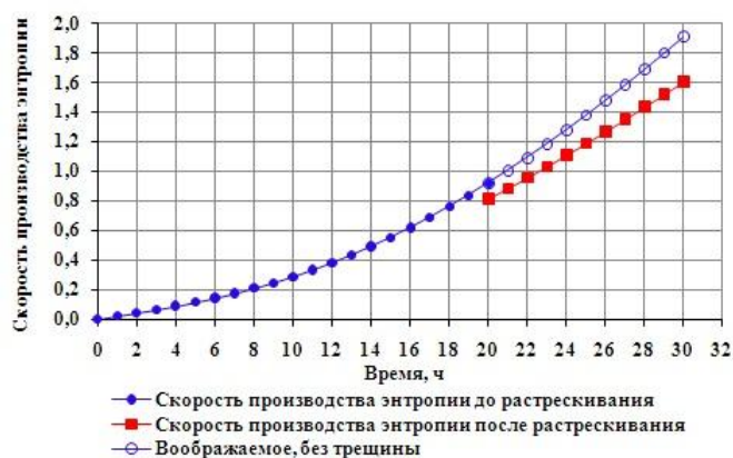
Рисунок 31. Изменение скорости производства энтропии до и после растрескивания асфальтобетонного покрытия
