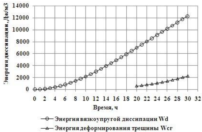
Рисунок 22. Изменение энергий вязкоупругой диссипации асфальтобетона ( W_d ) и деформирования трещины ( W_{cr} )
