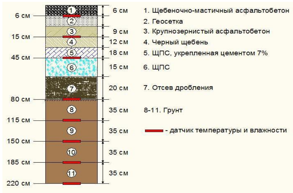
Рисунок 11. Схема расположения датчиков в дорожной конструкции
