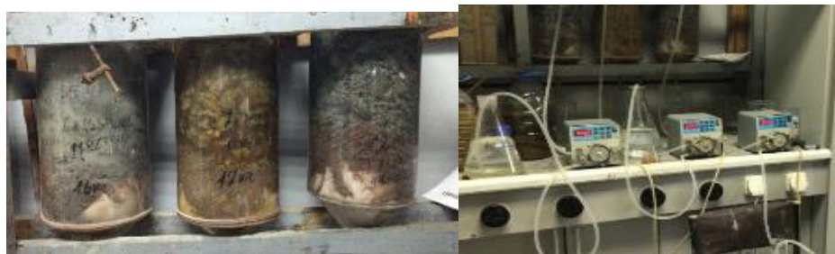
Рисунок 2 – Загруженные перколяторы для трех вариантов выщелачивания
